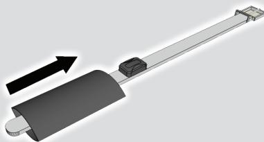
**FR** Passez la sangle du collier à travers la gaine de protection et recouvrez la balise GPS en centrant correctement la gaine.
